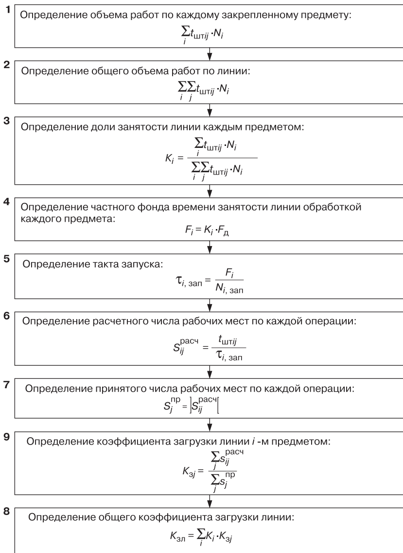
Рис. ПЗ.2. Алгоритм расчета многопредметной переменной поточной линии
