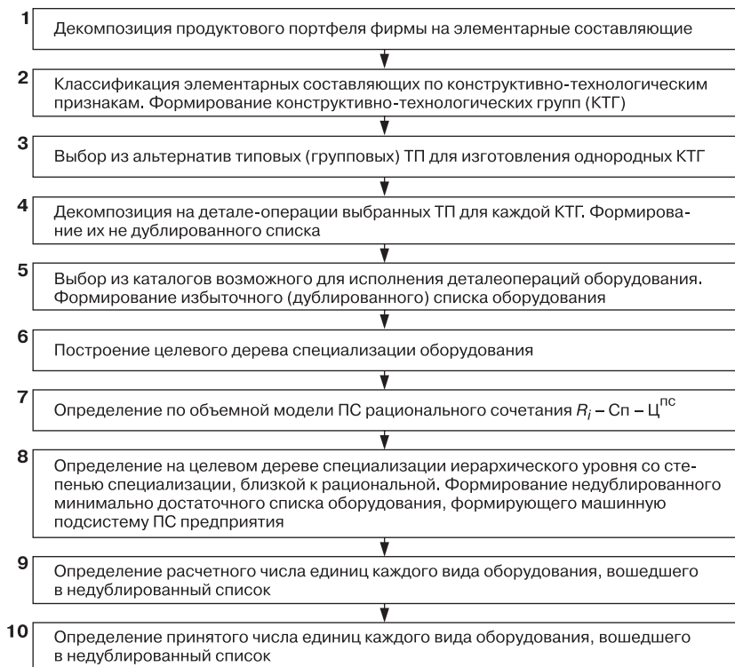
Рис. 7.10. Схема алгоритма проектирования новой машинной системы предприятия
